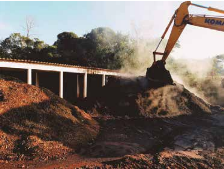
Maquinário, operado por funcionário do município, revolve a pilha de flores, galhos e folhas recolhidos pelas ruas da cidade como parte do processo de compostagem, acelerando a decomposição dos resíduos orgânicos
